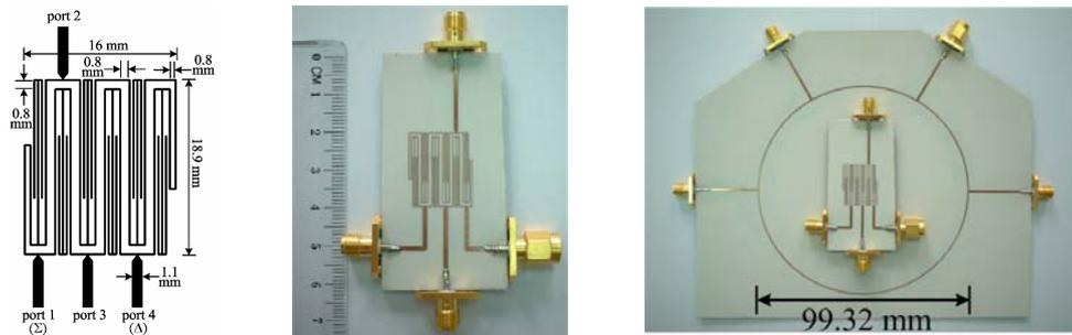
圖五 使用開路殘枝人工合成傳輸線研製微型化微波環形耦合器。
